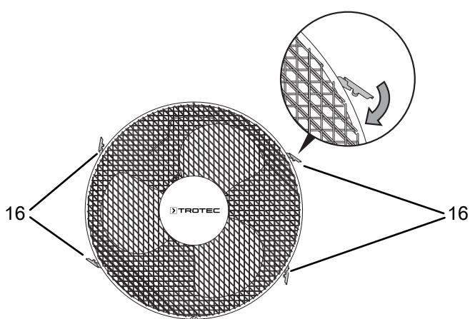
3. С помощью расположенного вверху крепежного винта (17) скрутите обе защитные решетки.
