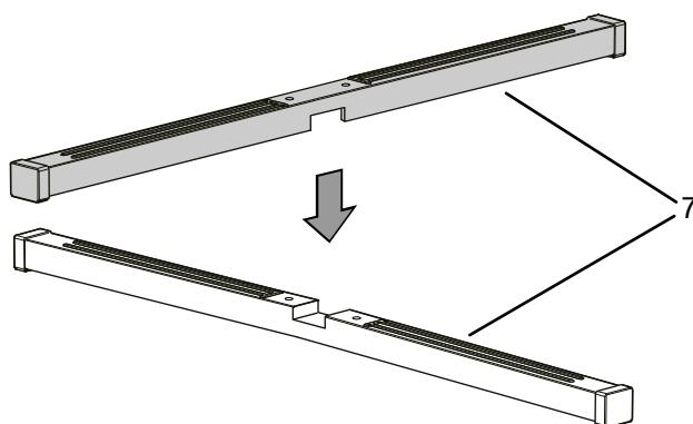
2. Установите стойку по центру на оба соединенных элемента ножки.
