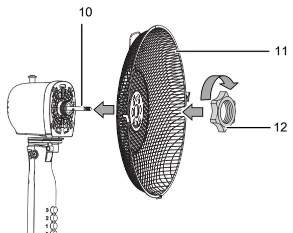
**Fixar a roda-hélice no fuso do motor**
