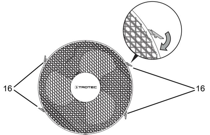
**Montaggio e chiusura della griglia di protezione**
