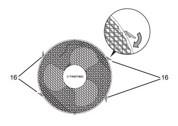
3. Vissez ensemble les deux parties de la grille de protection au moyen de la vis de fixation (17) située en haut de la grille.
