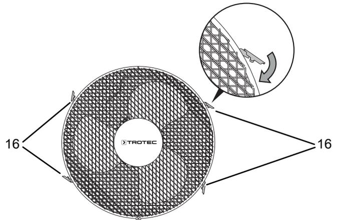
**Schutzgitter montieren und verschließen**
