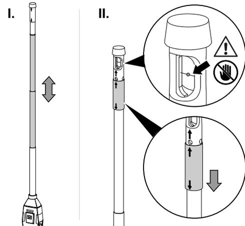
3. Tenez le capteur dans le flux objet de la mesure. La tête du capteur peut porter un marquage en forme de flèche. Tenez l'appareil de manière à ce que la flèche ou le côté avant de l'appareil portant la touche Marche/Arrêt/ Mesure (3) soit dirigée à l'encontre du flux pendant la mesure.
